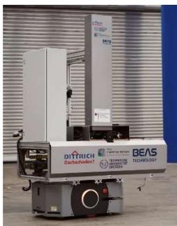
**Modulare Roboterplattform für das Bauhandwerk**
